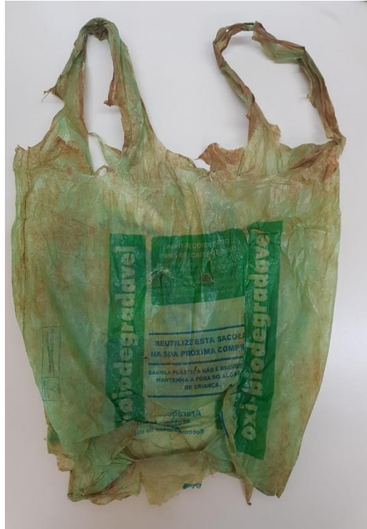
Figura 2: Aspecto visual da sacola oxibiodegradável após exposição em ambiente externo a ação do ar por 36 meses.
