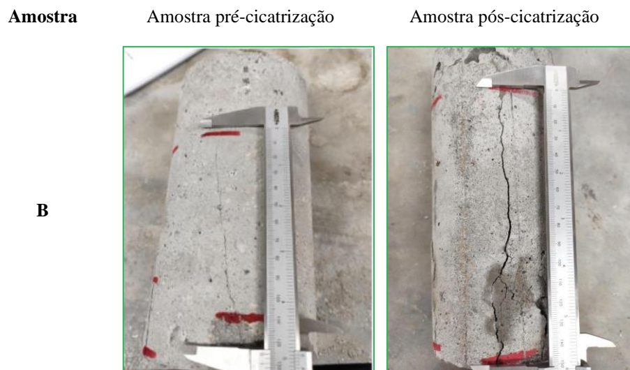
Figura 2 – Comparativo de Selamento de Fissuras Traços B e D.
