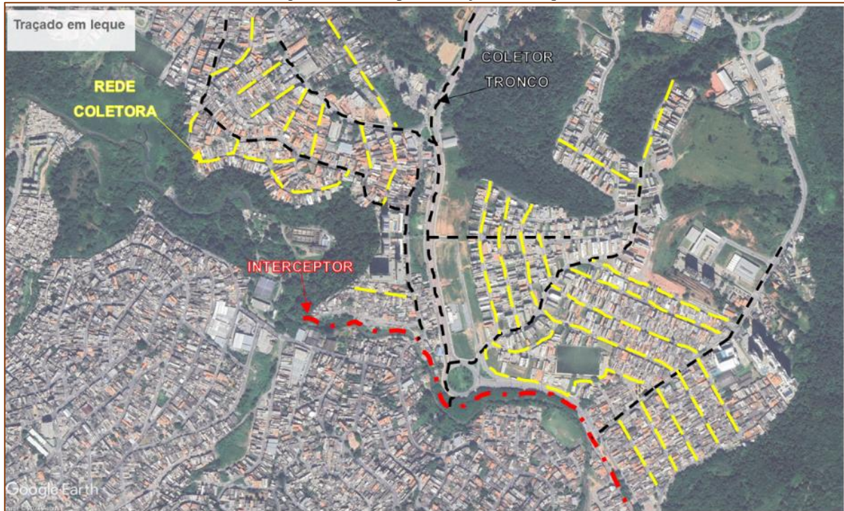
Figura 12- Exemplo de traçado em leque.
