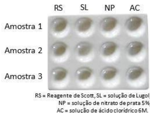
Figura 6: Distribuição correta das amostras e reagentes nas placas escavadas, para a identificação dos simulacros de cocaína e seus diluentes, através da utilização das informações contidas no Anexo 1. Fonte: Autoria própria.
