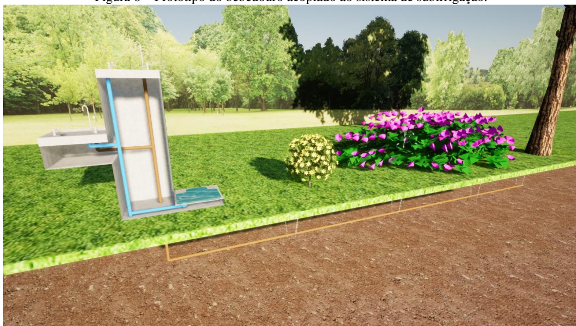
Figura 6 – Protótipo do bebedouro acoplado ao sistema de subirrigação.
