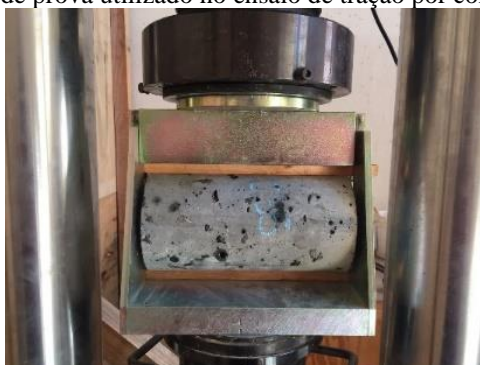
Figura 10 - Corpo de prova utilizado no ensaio de tração por compressão diametral.
