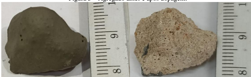
Figura 5 – Agregado antes e após dopagem.
