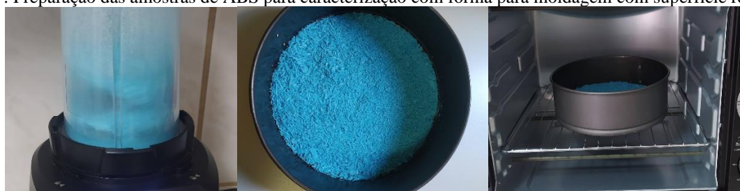
Figura 7: Preparação das amostras de ABS para caracterização com fôrma para moldagem com superfície removível.
