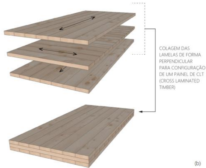
Figura 1– Configuração do painel de CLT
