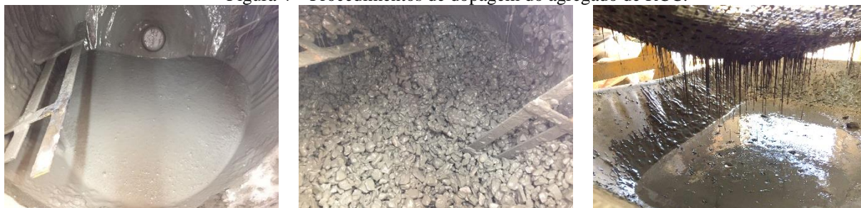
Figura 4 – Procedimentos de dopagem do agregado de RCC.
