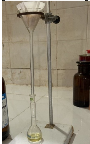
Figura 12. Sistema de filtragem
