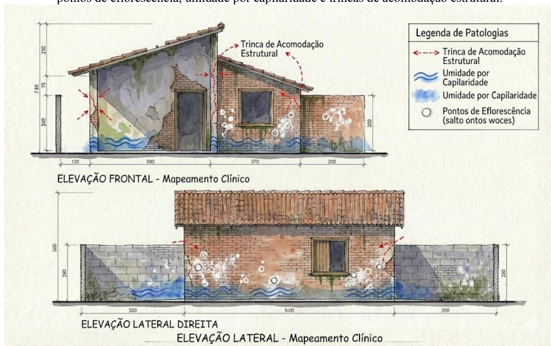
Figura 03: Mapeamento clínico em elevação (desenho técnico híbrido). Indicação precisa de patologias físicas: pontos de eflorescência, umidade por capilaridade e trincas de acomodação estrutural.
