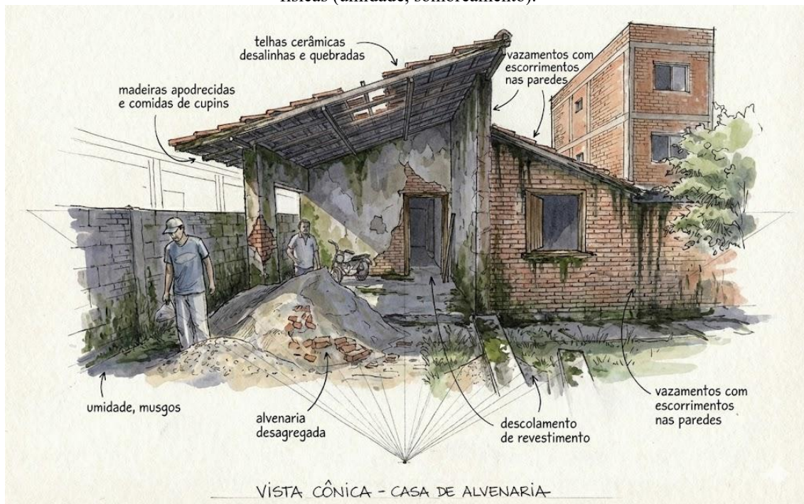
Figura 02: Levantamento e mapeamento tectônico do estado original da casa, com setas indicando patologias físicas (umidade, sombreamento).
