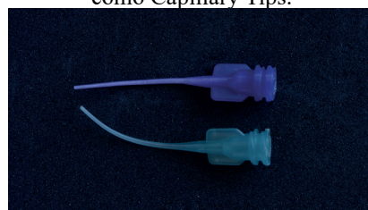
Figura 31 - Pontas de diâmetro menor, conhecidas como Capillary Tips .
