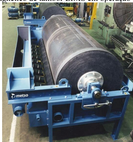
Figura 7. Separador magnético de tambor LIMS em operação industrial (Metso, 2025)
