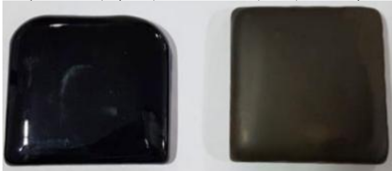
Figura 7 - Peças de vidro (esquerda) e vitro-cerâmica (direita) obtidas a partir do rejeito
