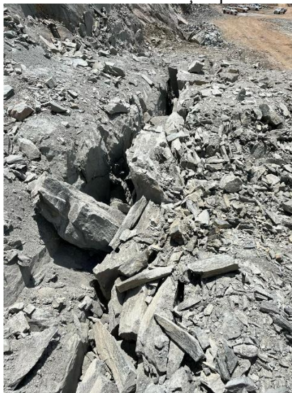
Figura 11 - Local da detonação pós desmonte.
