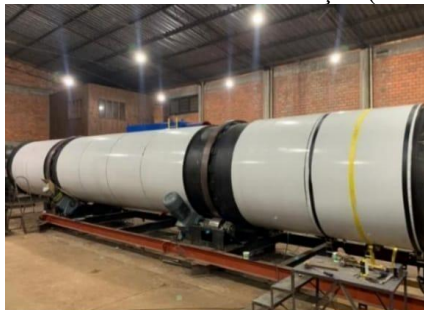
Figura 9. Secador rotativo em fabricação (Santos, 2024)
