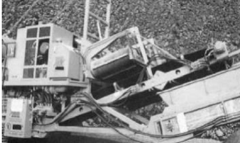
Figura 4. Separador magnético Steinert de correia cruzada (Svoboda, 2003)
