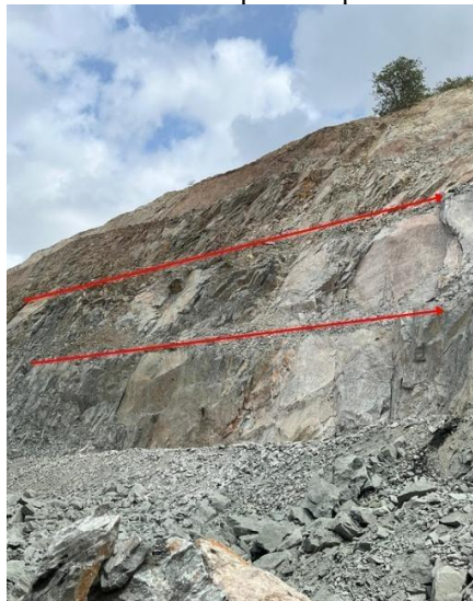
Figura 2 - Paredão formado por má qualidade de bermas.
