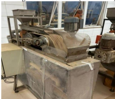
Figura 10. Tambor magnético 1400 Gauss (Modelo RE) (Santos, 2024)
