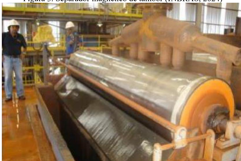
Figura 3. Separador magnético de tambor (INBRAS, 2024)
